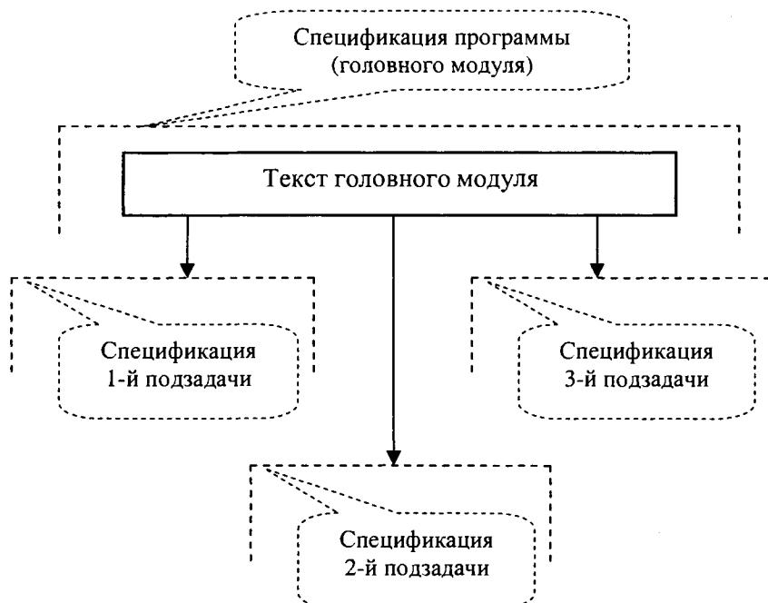
**Рис. 7.1.** Первый шаг формирования модульной структуры программы при конструктивном подходе
